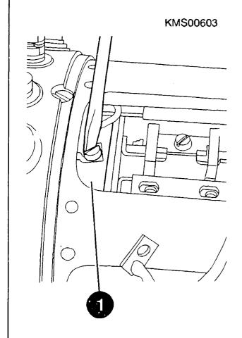
CONNECTING STARTING-MOTOR SOLENOID WITH CONTROL RELAY
